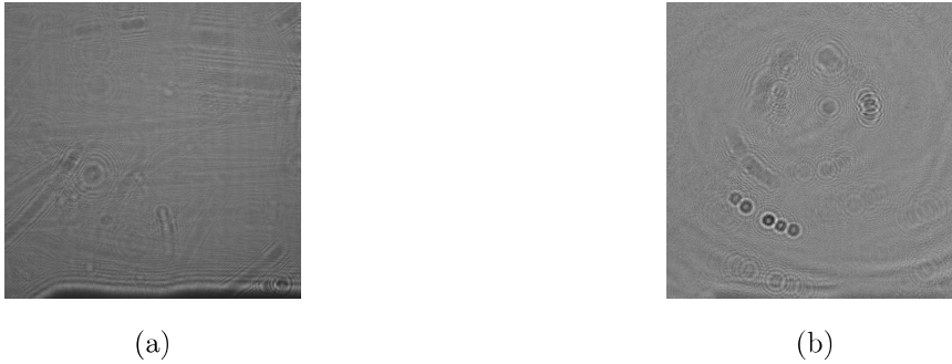
FIGURE III.5: Exemple de normalisation d'hologramme multi-exposition (a) l'hologramme brut, (b) l'hologramme normalisé
