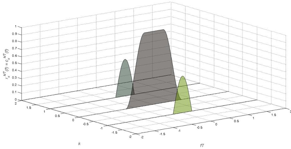
FIGURE A.2 – Densité Spectrale de puissance cyclique pour une modulation rectiligne ( $r_{\frac{k}{T}}(f) \equiv c_{\frac{k}{T}}(f)$ ) BPSK avec une impulsion de mise en forme de Nyquist de roll-off  $\alpha_{ro} = 0.5$
