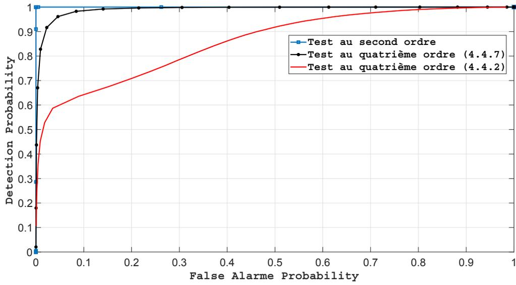
FIGURE 4.5 – Courbes ROC pour SNR = -3dB et  $K = 1000$
