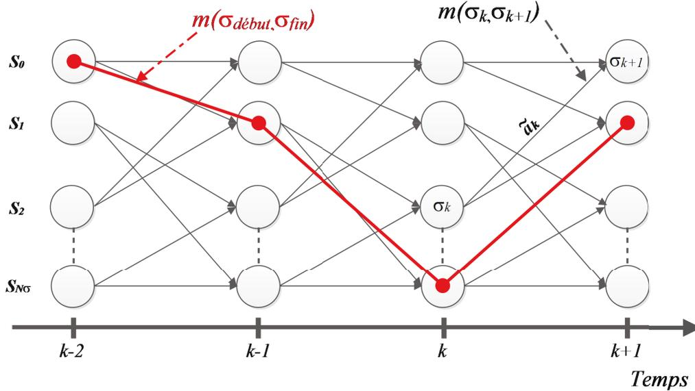
FIGURE A.28 – Treillis à  $N_\sigma = (\text{card}\mathcal{A})^{L_i}$  états pour la détection au sens ML d'un signal modulée linéairement à deux états ( $\text{card}\mathcal{A} = 2$ )<sup>6</sup> et transmis à travers un canal sélectif en fréquence (étendue du canal discret équivalent =  $L_i + 1$ ).
