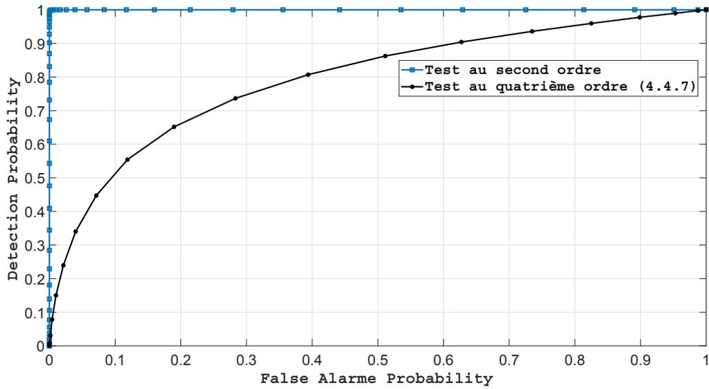
FIGURE 4.6 – Courbes ROC pour SNR = -6dB et  $K = 1000$
