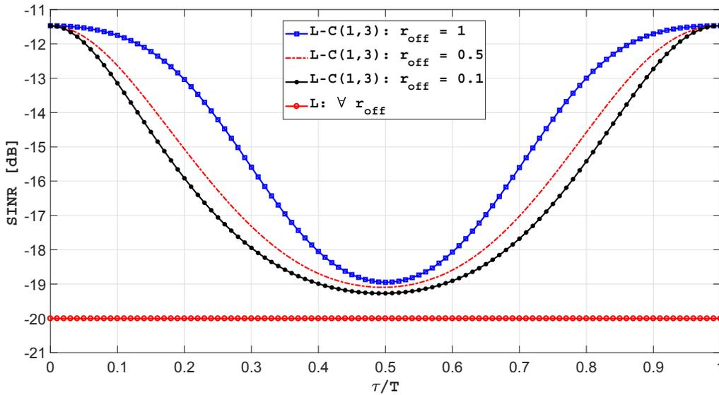
FIGURE 3.15 –  $\text{SINR}_{\text{LC}(1,3)}$  et  $\text{SINR}_L$  pour des symboles SOI et CCI 16QAM en fonction du  $\tau/T$  pour  $\text{SNR} = 10\text{dB}$ ,  $\text{INR} = 30\text{dB}$  et  $\forall \phi$ .
