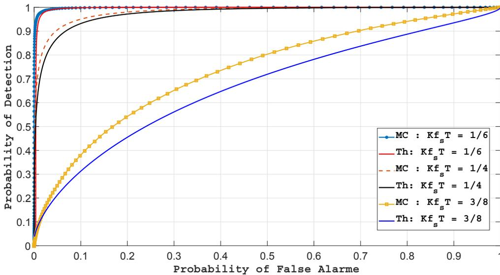
FIGURE 4.3 – Courbes ROC pour SNR = 0dB et  $K = 100$ .
