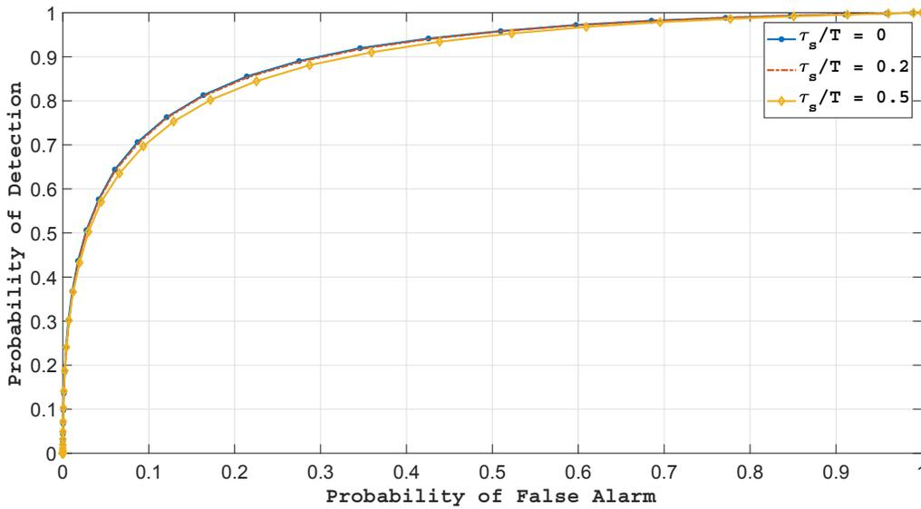
FIGURE 4.2 – Courbes ROC pour SNR = -3dB et  $k = 50$ .
