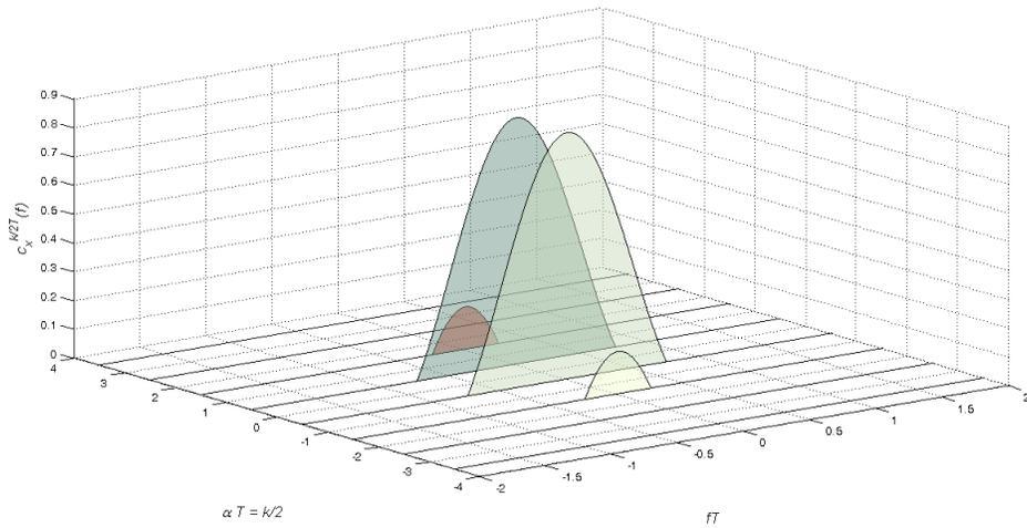
FIGURE A.10 – Densité Spectrale de puissance cyclique complémentaire  $c_{x^k}^{\frac{k}{2T}}(f)$  pour une modulation quasi-rectiligne 4-OQAM avec une impulsion de mise en forme de Nyquist de roll-off  $\alpha_{ro} = 1$
