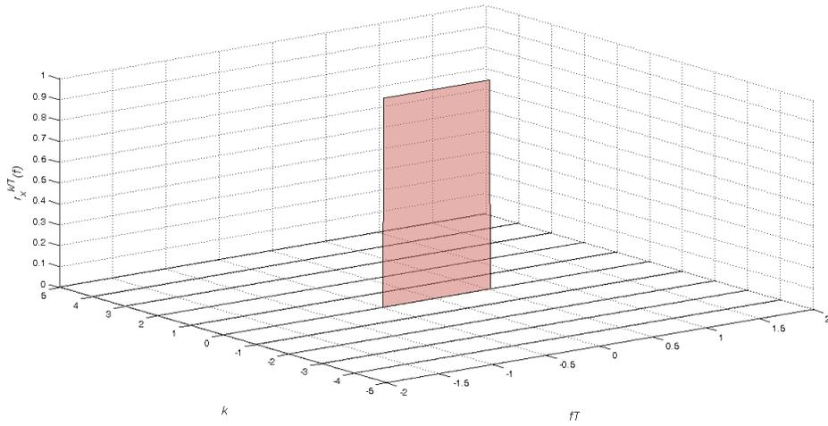
FIGURE A.5 – Densité Spectrale de puissance cyclique  $r_{x^k}^{\frac{k}{T}}(f)$  pour une modulation quasi-rectiligne 4-OQAM avec une impulsion de mise en forme de Nyquist de roll-off  $\alpha_{ro} = 0$
