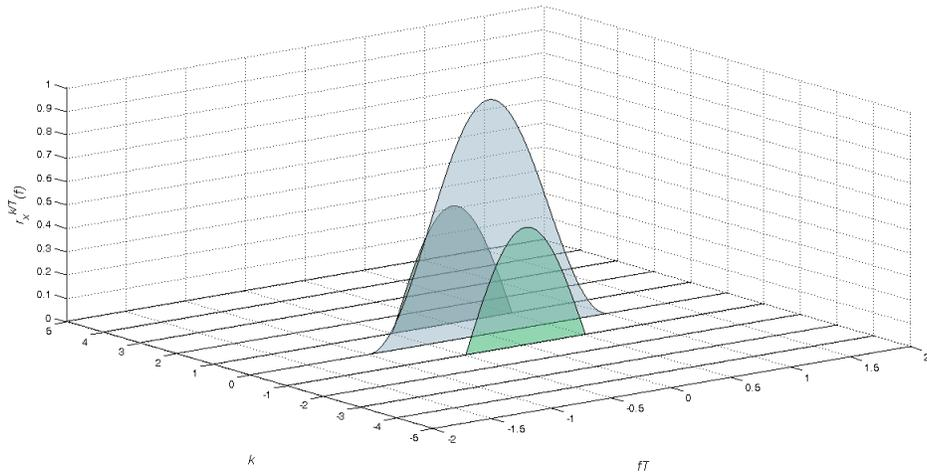
FIGURE A.9 – Densité Spectrale de puissance cyclique  $r_{x^k}^{\frac{k}{T}}(f)$  pour une modulation quasi-rectiligne 4-OQAM avec une impulsion de mise en forme de Nyquist de roll-off  $\alpha_{ro} = 1$
