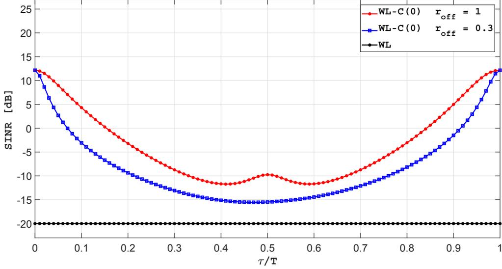
FIGURE 3.10 –  $\text{SINR}_{\text{WL-C}(0)}$  et  $\text{SINR}_{\text{WL}}$  pour symboles SOI et CCI BPSK en fonction de  $\tau/T$  pour  $\phi = 0$ ,  $\text{SNR} = 10\text{dB}$  et  $\text{INR} = 30\text{dB}$ .
