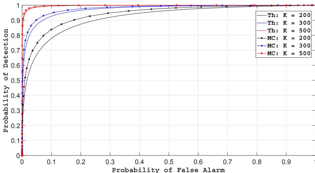
FIGURE 4.1 – Courbes ROC pour SNR = -5dB.
