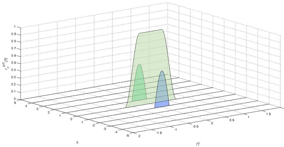
FIGURE A.7 – Densité Spectrale de puissance cyclique  $r_{x^k}^{\frac{k}{T}}(f)$  pour une modulation quasi-rectiligne 4-OQAM avec une impulsion de mise en forme de Nyquist de roll-off  $\alpha_{ro} = 0.4$
