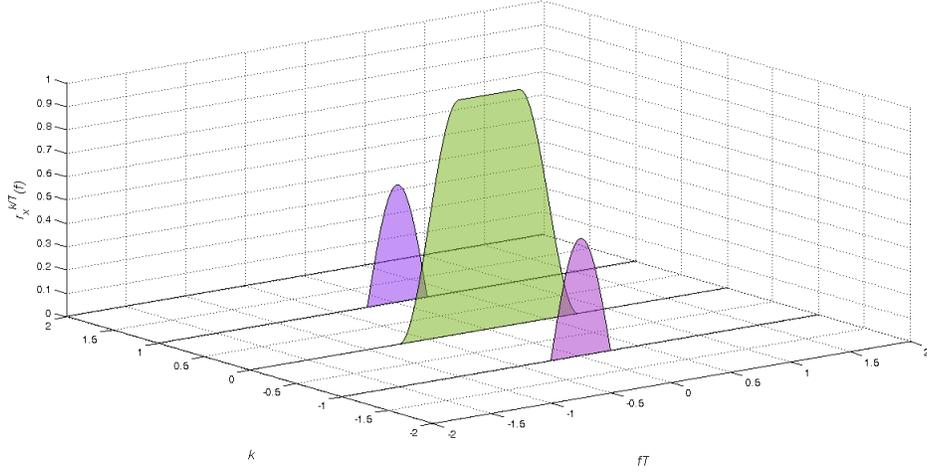
FIGURE A.4 – Densité Spectrale de puissance cyclique pour une modulation circulaire ( $c_x^{\frac{k}{T}}(f) \equiv 0$ ) 4-QAM avec une impulsion de mise en forme de Nyquist de roll-off  $\alpha_{ro} = 0.5$
