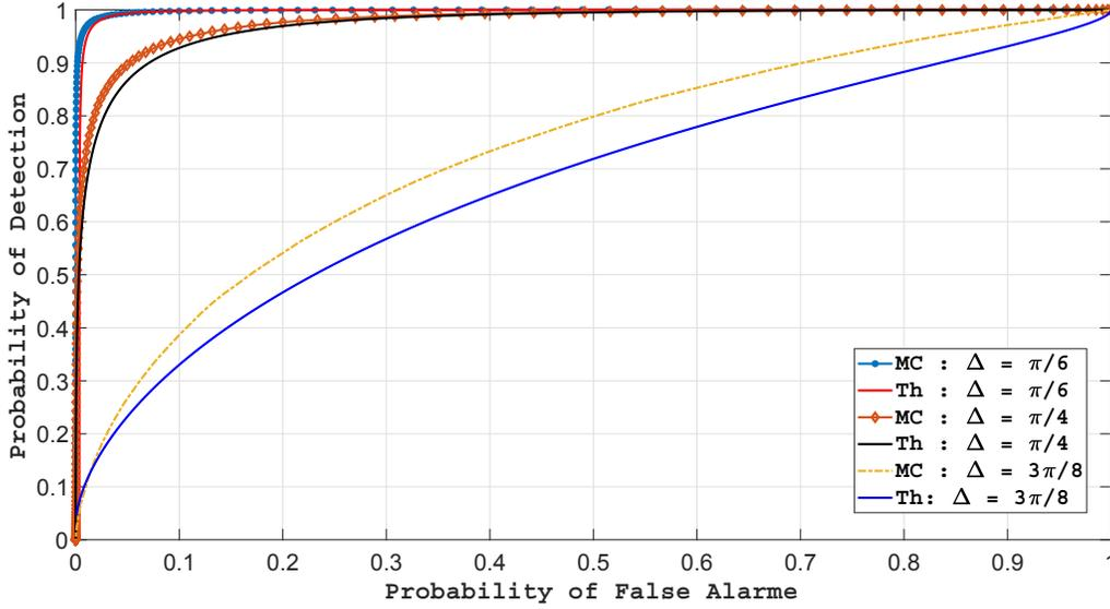
FIGURE 4.4 – Courbes ROC pour SNR = 0dB et  $K = 100$ .
