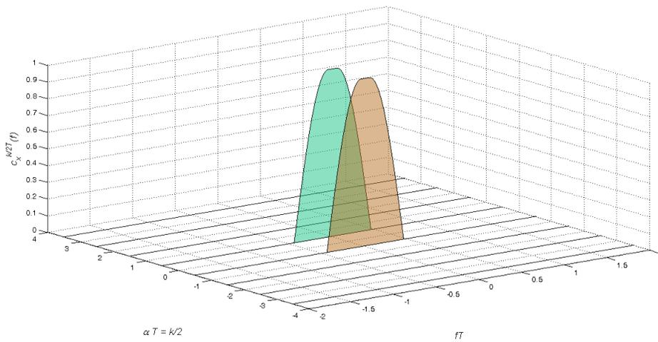
FIGURE A.8 – Densité Spectrale de puissance cyclique complémentaire  $c_{x^k}^{\frac{k}{2T}}(f)$  pour une modulation quasi-rectiligne 4-OQAM avec une impulsion de mise en forme de Nyquist de roll-off  $\alpha_{ro} = 0.4$
