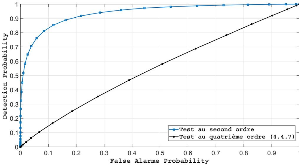
FIGURE 4.7 – Courbes ROC pour SNR = -10dB et  $K = 1000$
