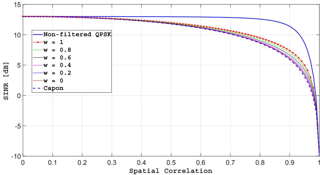
FIGURE 2.15 –  $SINR_{L-C(1,3)}$  en fonction de la corrélation spatiale  $\alpha$  pour une interférence QPSK avec  $INR = 20dB$ .
