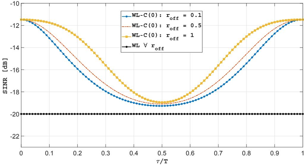
FIGURE 3.11 –  $\text{SINR}_{\text{WL-C}(0)}$  et  $\text{SINR}_{\text{WL}}$  pour symboles SOI et CCI 4ASK en fonction de  $\tau/T$  pour  $\phi = 0$ ,  $\text{SNR} = 10\text{dB}$  et  $\text{INR} = 30\text{dB}$ .
