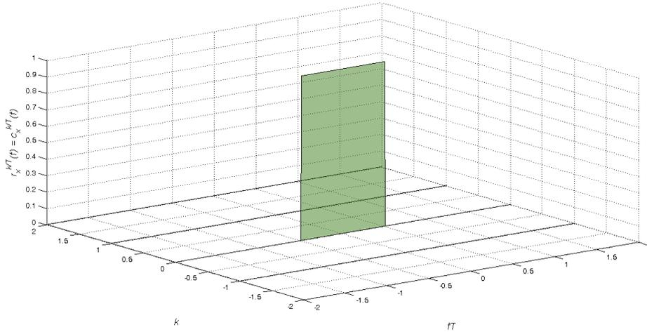
FIGURE A.1 – Densité Spectrale de puissance cyclique pour une modulation rectiligne ( $r_x^{\frac{k}{T}}(f) = c_x^{\frac{k}{T}}(f)$ ) BPSK avec une impulsion de mise en forme de Nyquist de roll-off  $\alpha_{ro} = 0$
