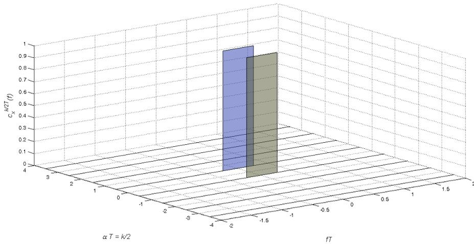
FIGURE A.6 – Densité Spectrale de puissance cyclique complémentaire  $c_{x^k}^{\frac{k}{2T}}(f)$  pour une modulation quasi-rectiligne 4-OQAM avec une impulsion de mise en forme de Nyquist de roll-off  $\alpha_{ro} = 0$
