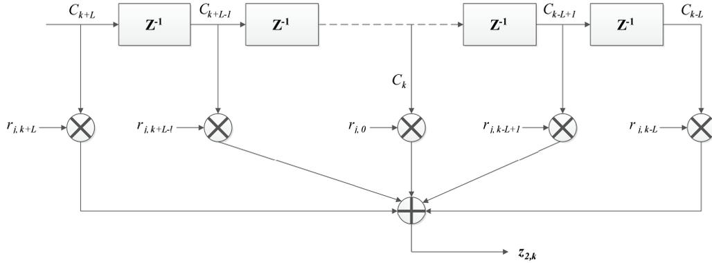
FIGURE A.18 – Générateur des échantillons de l'interférence
