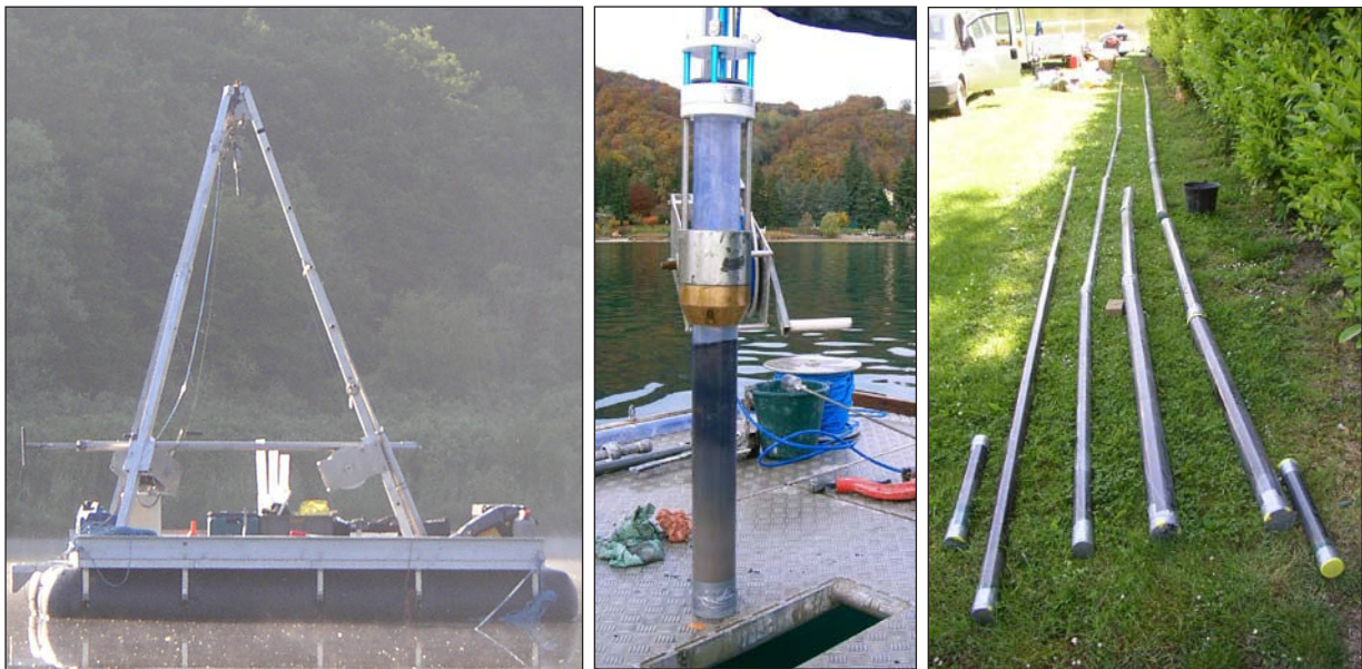
Figure 2.2 - (a) Plateforme de forage ; (b) carottier d'interface ; (c) photos des différentes sections prélevées dans le lac de Moras dans des carottages parallèles
