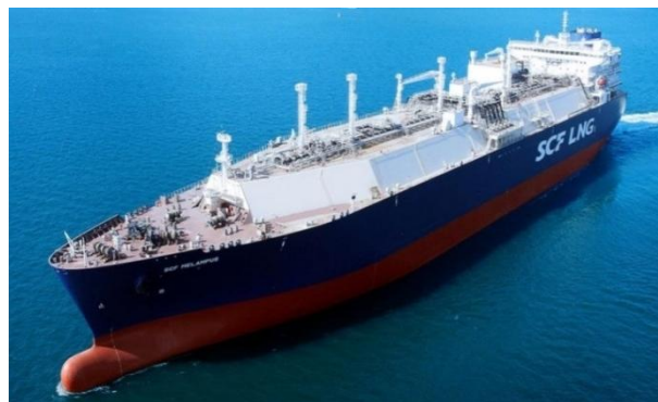
Figure 1-1 : Transport maritime du gaz naturel – Méthanier équipé de cuves de technologie GTT (source GTT)
