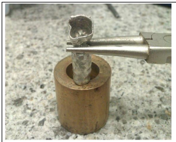
Figure 3-8. Capsule en étain utilisée en analyse thermique différentielle à haute pression
