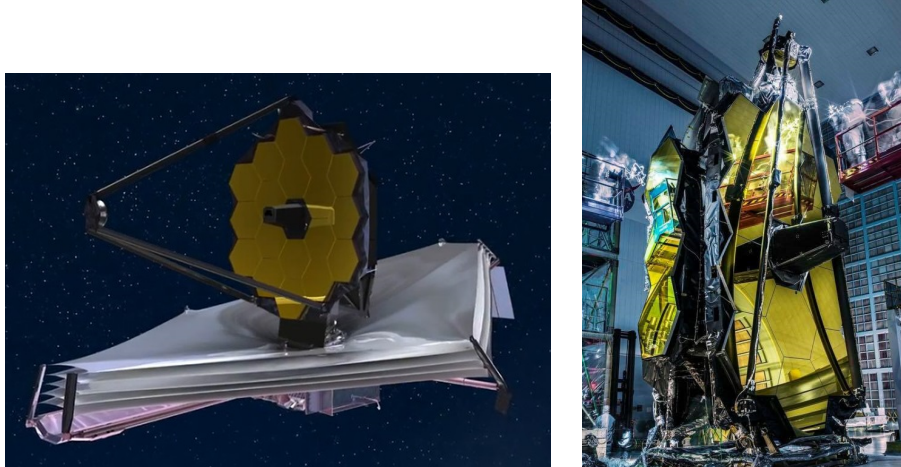
FIGURE 1.5 – Gauche : James Webb Space Telescope, vue d'artiste. Droite : Miroir primaire du James Webb Space Telescope, en salle d'intégration, replié. Crédits : NASA
