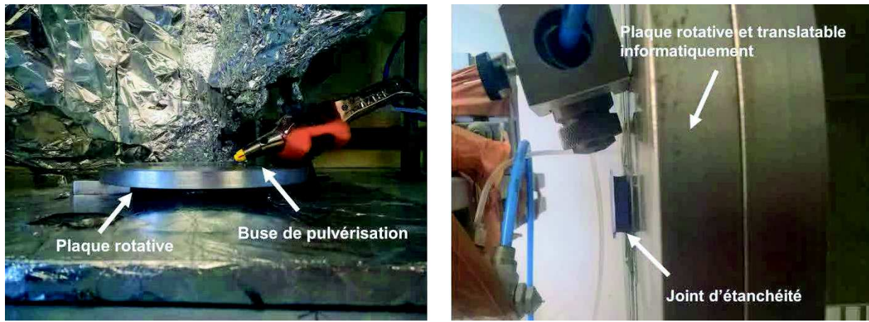
Figure 25 : (De gauche à droite) Plateforme pour la réalisation des échantillons conducteurs, Plateforme pour la réalisation des échantillons optiques
