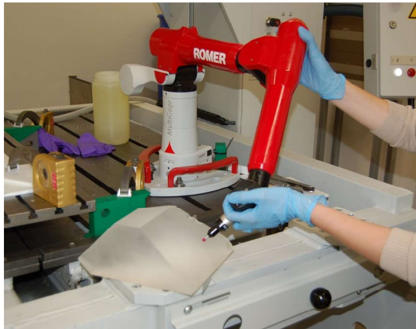
Figure 17 : Bras palpeur utilisé pour la reconstruction en 3D d'un cristal
