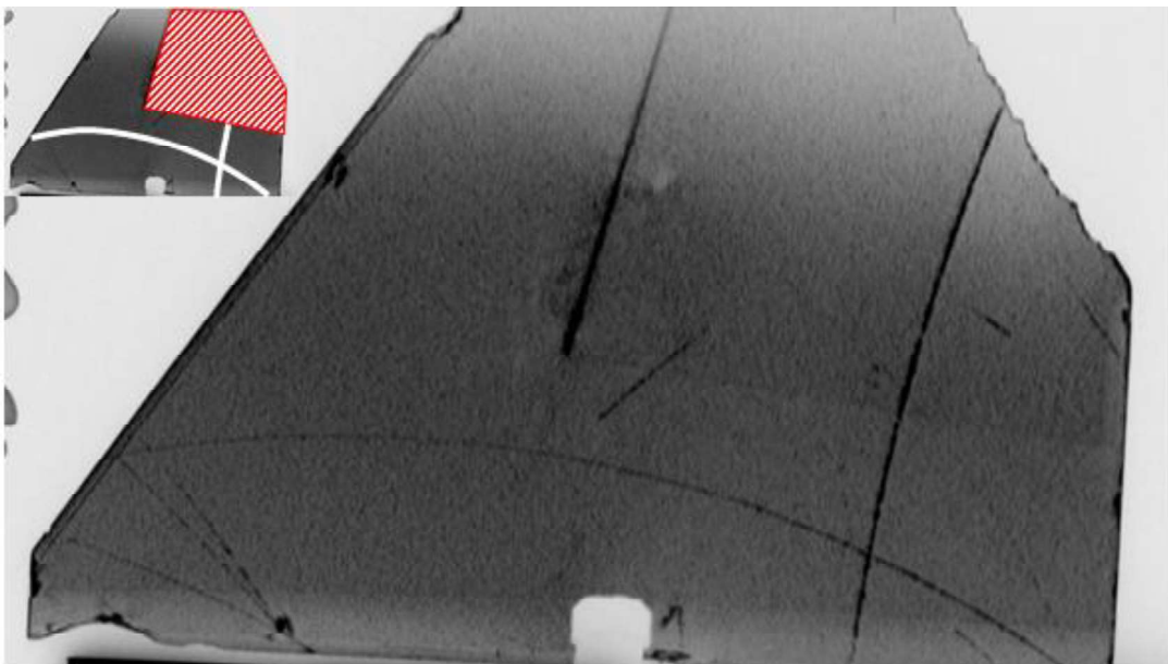
Figure 7 : Topographie aux RX de la lame KDPJ04 – Face {101} - Utilisation de la réflexion (020)
