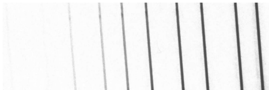
Figure 22 : Échelle de contraste obtenue sur le diffractomètre de topographie aux RX pour différents temps d'exposition (1 à 30 s)
