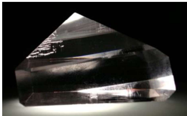
Figure 33 : Illustration du Crazing sur un cristal de DKDP tiré de [28]
