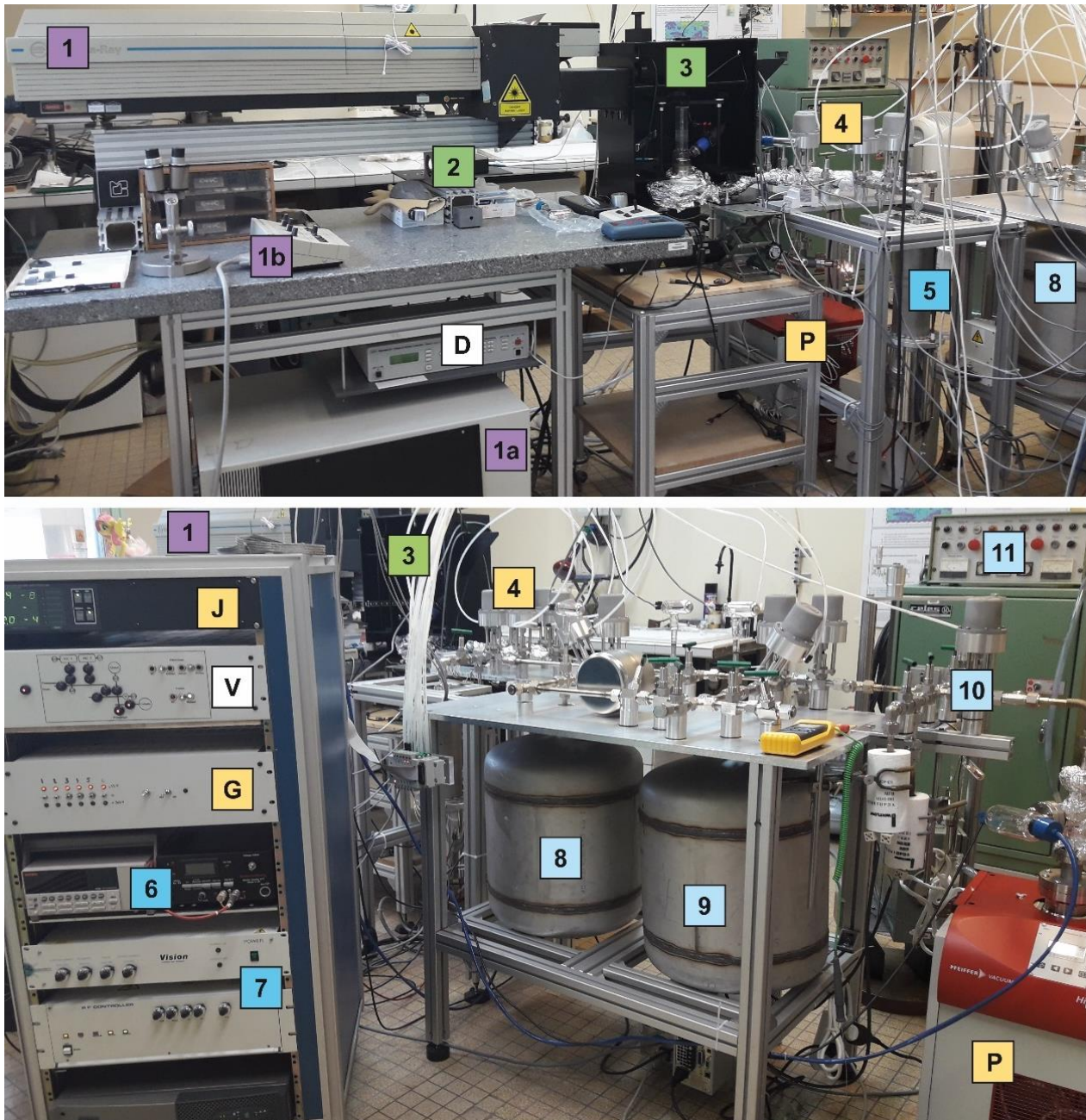
Figure III-18 : Dispositif expérimental KArMars développé durant cette thèse : 1. Laser UV ; 1a. Alimentation laser ; 1b. Console de commande laser ; 2. Spectromètre optique ; 3. Boîtier optique ; 4. Ligne de purification sous ultravide ; 5. Spectromètre de masse quadripolaire (QMS) ; 6. Alimentation du multiplicateur d'électrons du QMS et Keithley 6514 pico-ampèremètre ; 7. Radiofréquence du QMS ; 8. Volume d'argon calibré pour définir la sensibilité du multiplicateur d'électrons du QMS ; 9. Volume d'argon calibré pour définir la sensibilité de la cage de faraday du QMS ; 10. Système d'analyse d'échantillons standards pour vérifier les volumes calibrés ; 11. Four à induction haute fréquence ; D. Contrôleur de la platine de déplacement x, y et z ; V. Interface contrôlant les vannes pneumatiques et l'obturateur laser ; P. Pompe turbo-moléculaire ; J. Affichage jauge de pression et G. Interface contrôlant les getters Al-Zr.
