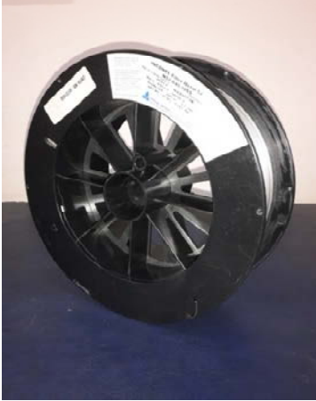
Figure 2-4 : Bobine de FM52 fournie par AREVA
