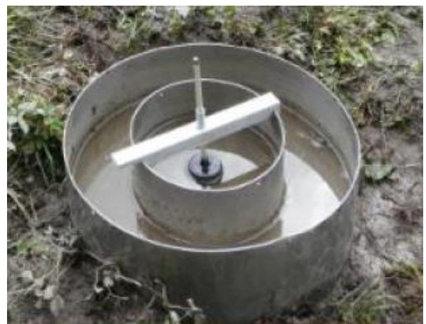
Figure 7 : Photo de l'infiltromètre à double anneau.
