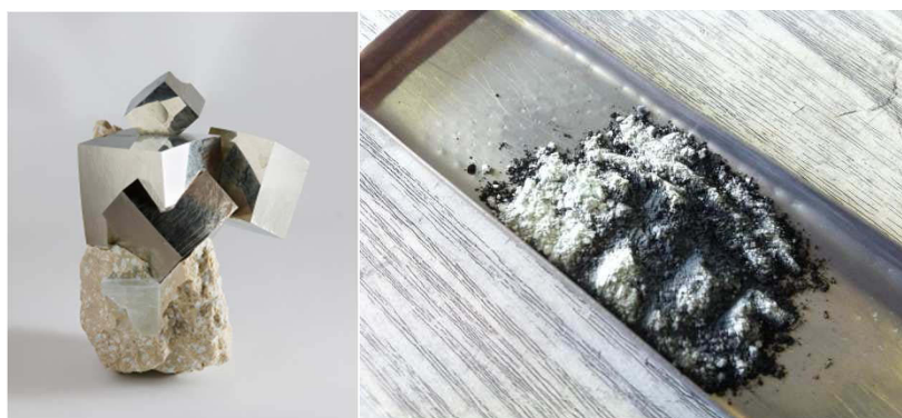
Figure 67 : Echantillon de FeS 2 avant fluoration (à gauche) et après fluoration (à droite)
