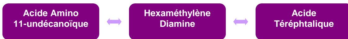
Figure II- 4 Schéma général de la synthèse d'un copolyamide 11/6.T
