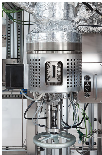
Figure IV- 3 Photographie du corps du réacteur et de la vanne de fond
