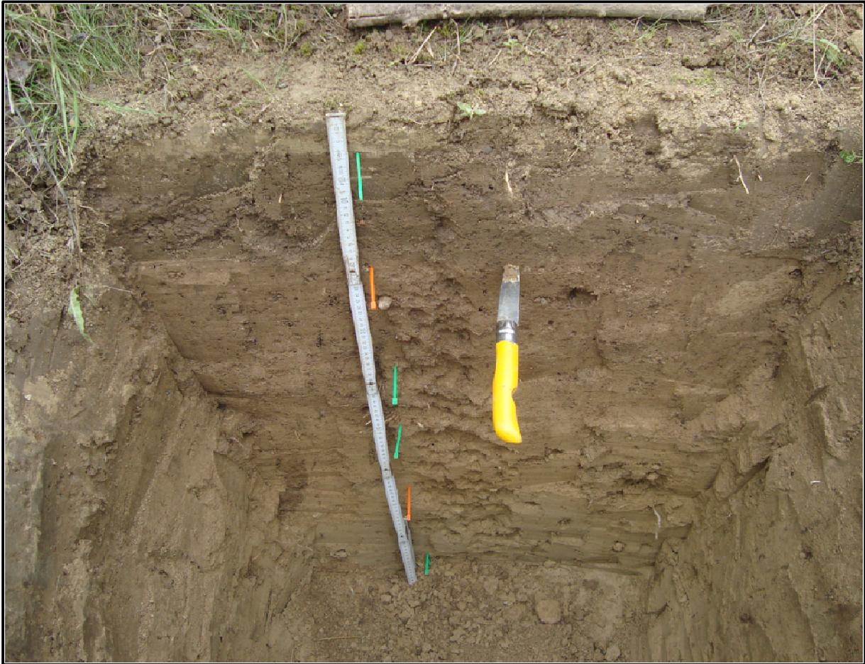
**Figure 2-13: Photo représentant la fosse creusée dans la noue C de Colmar. Les pics de couleurs montrent la limite entre les différents horizons. (Source personnelle)**
