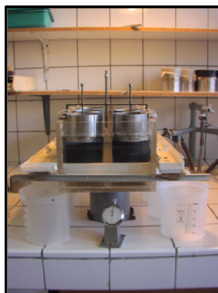
Figure 2-17: Mesure du K_s par la méthode du perméamètre à charge constante. (Source : Laboratoire des sols UNISTRA)
