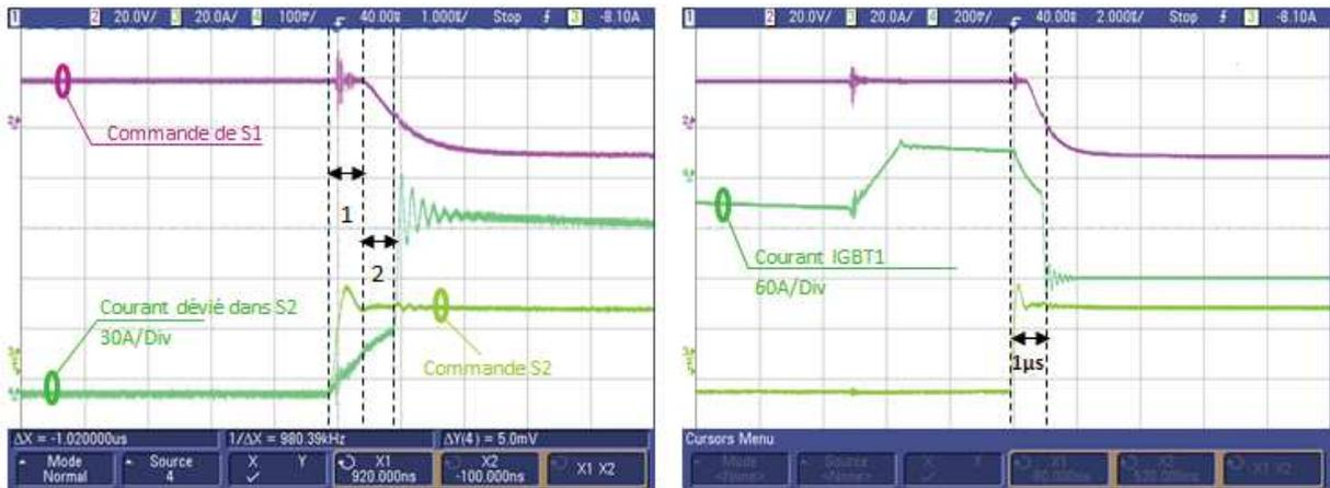
Figure 2-48 – Interruption du courant par le circuit auxiliaire de roue libre
