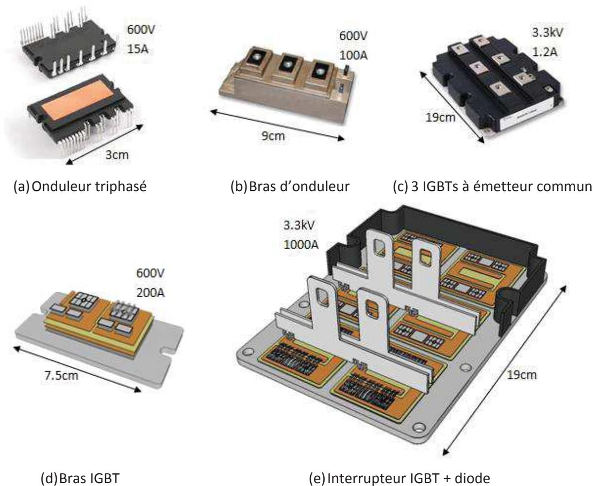
Figure 1-1– Différentes formes de modules de puissance
