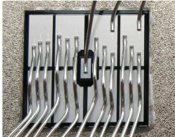
Figure 1-6 – Contacts par fils de bonding d'une puce IGBT
