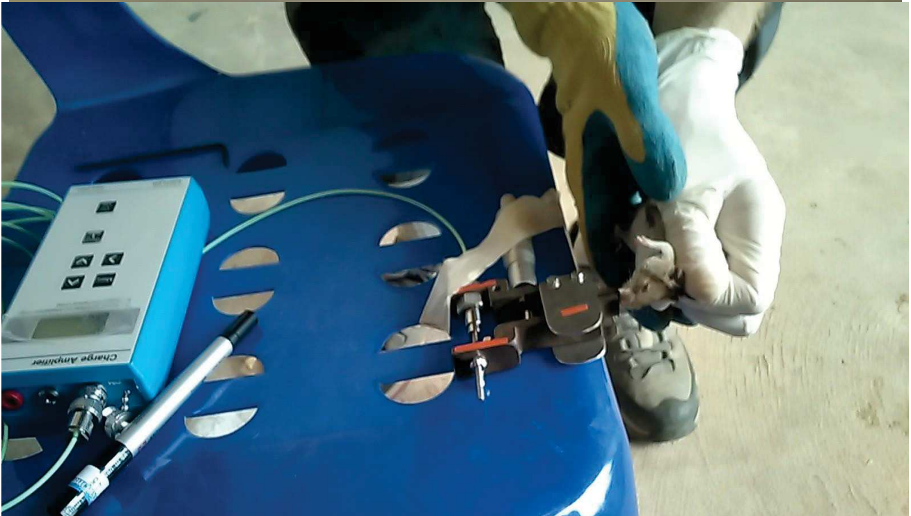
Figure 7. A) Le transducteur de force utilisé pour mesurer les forces de morsures des rongeurs. Les plaques métalliques à droite de l'image permettent à l'animal de mordre et transmettent par levier une force de tension au piézomètre relié par un câble à l'amplificateur situé à gauche. B) Une souris mordant sur le transducteur de force lors d'une mission de terrain en Thaïlande.
