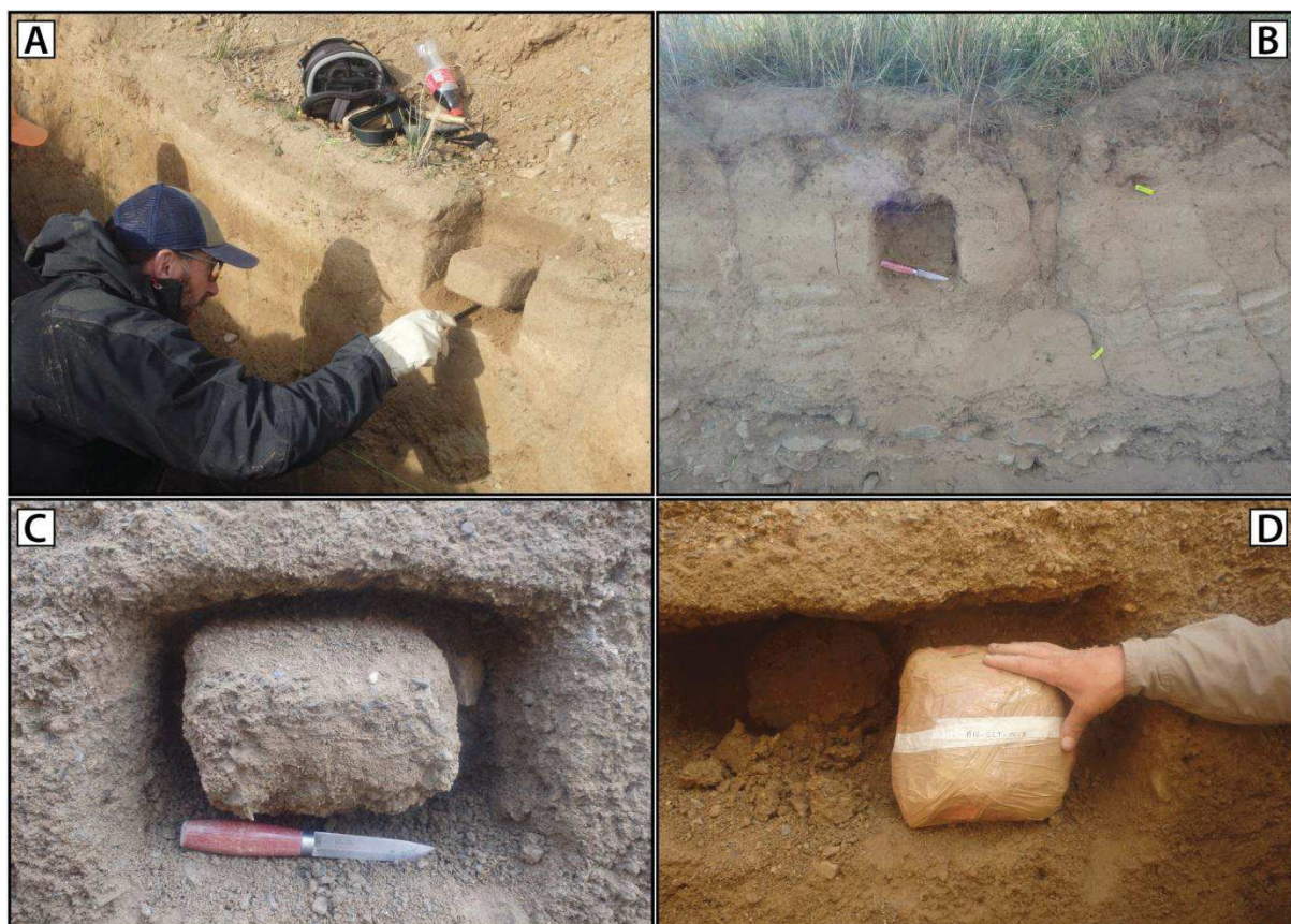
Figure 2-15 : Echantillonnage par bloc OSL. A. Site de Rain Creek tranchée 2 (WBF), B. Site de Rain Creek Riser (WBF). C. Tranchée de Moskito Creek (WBF). D. Tranchée de Swan Lake (WBF). Noter l'emballage, composée de plusieurs couches, successivement imperméables (film plastique), opaques (feuille aluminium) et protectrices (adhésif toilé).
