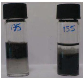
Figure 43 : Etude de la dispersion a) du GO-PE-voie solvant et b) du GO-penta-BPO-voie directe à 0,36 mg/mL après 30min de sonication dans un milieu immiscible d'heptane (en haut) et de DMF (en bas) (1:1/v:v)
