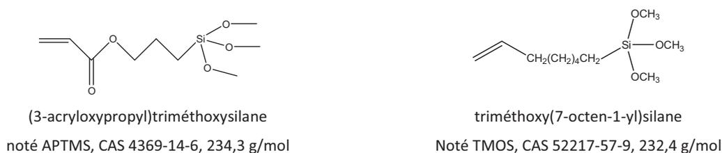
**Figure 13 : Composition des réactifs pour l'hydrolyse/condensation type triméthoxysilane vinylique**
