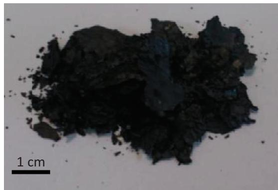
Figure 18 : Photographie du graphite oxydé séché
