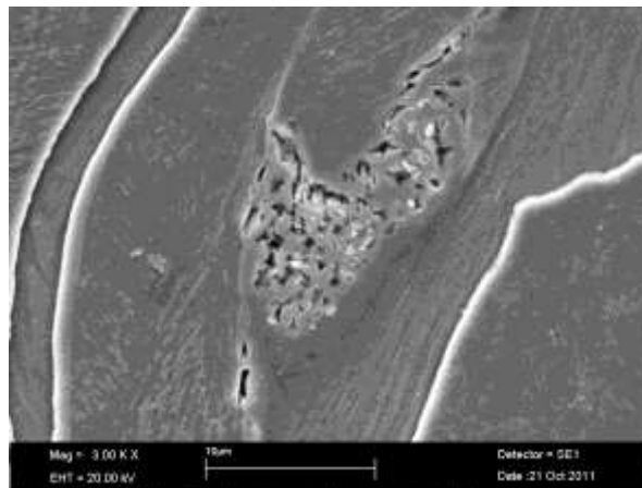
Figure VI.7 : Observation au MEB de la précipitation inattendue dans un copeau de 1.4362 10303H Ø73+TTh1. Le copeau provient d'un essai Quick-Stop avec une avance f=0,4\text{mm/tr} .
