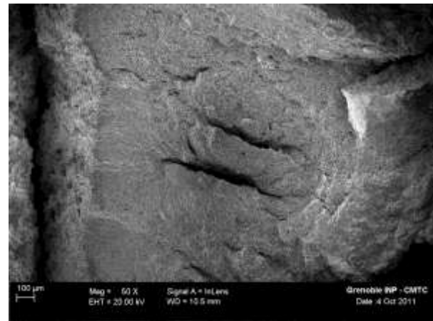
Figure VI.5: Fractographies montrant les fissures transversales pour 1.4362Nb_Moyen T=-75°C (MEB/FEG).
