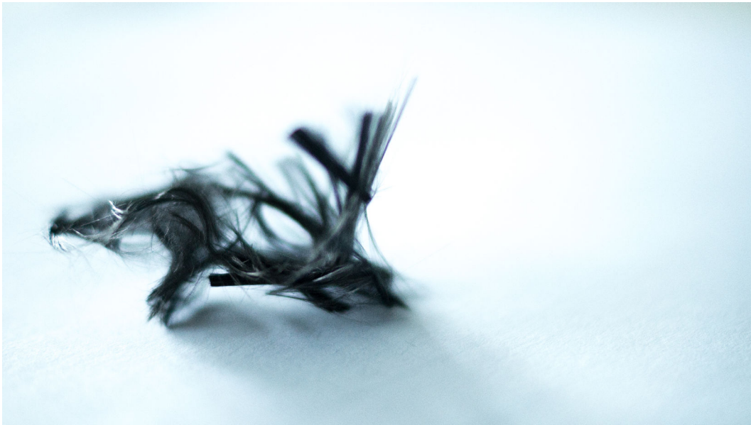
FIGURE 4.1 – Fibres recyclées en sortie du traitement de PRFC par vapo-thermolyse
