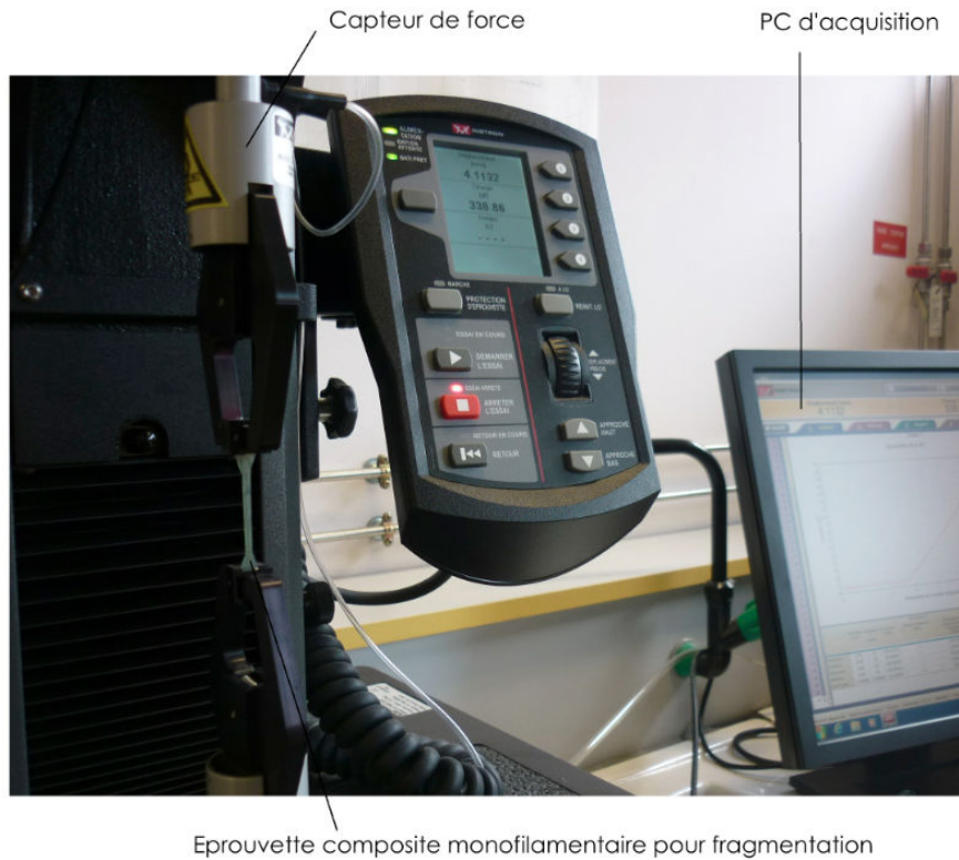
FIGURE 2.16 – Montage expérimental du Single Fibre Fragmentation Test
