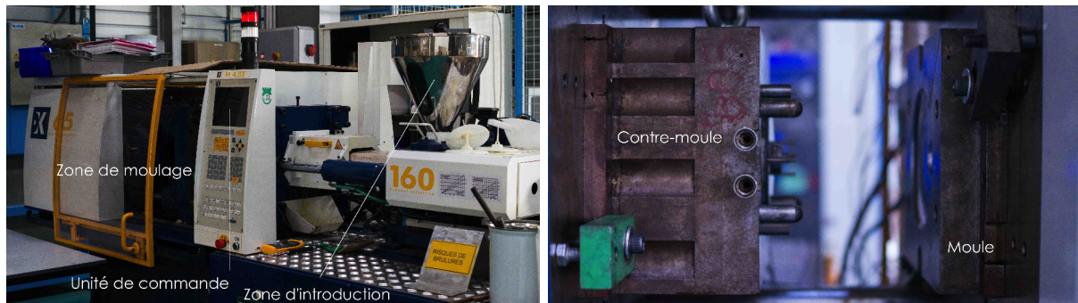
FIGURE 2.21 – Photographie de la presse d'injection DK-Codim et de son moule
