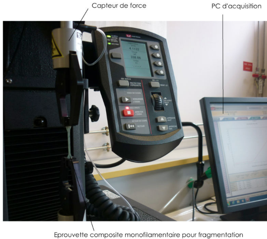
FIGURE 2.16 – Montage expérimental du Single Fibre Fragmentation Test
