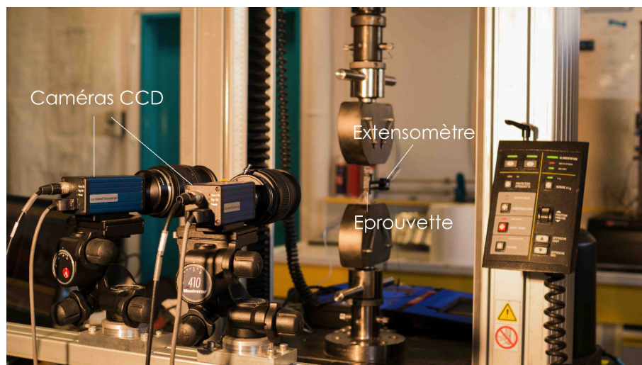
FIGURE 2.28 – Photographie du montage expérimental de stéréovision pendant un essai mécanique
