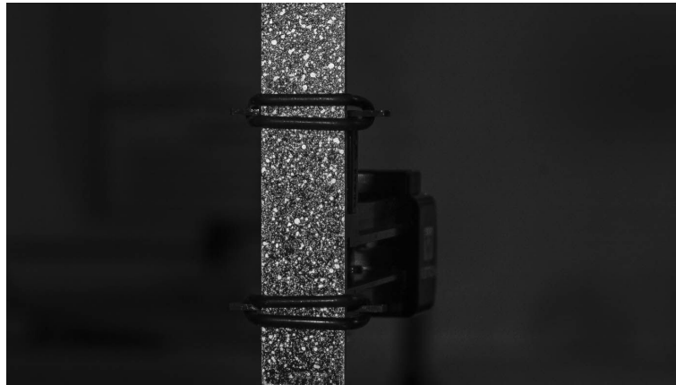
FIGURE 2.26 – Photographie de la surface d'une éprouvette durant un essai de traction suivi par stéréovision
