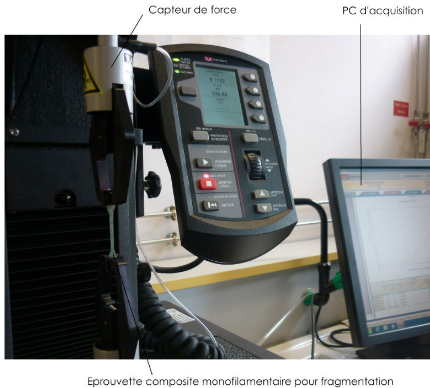
FIGURE 2.16 – Montage expérimental du Single Fibre Fragmentation Test
