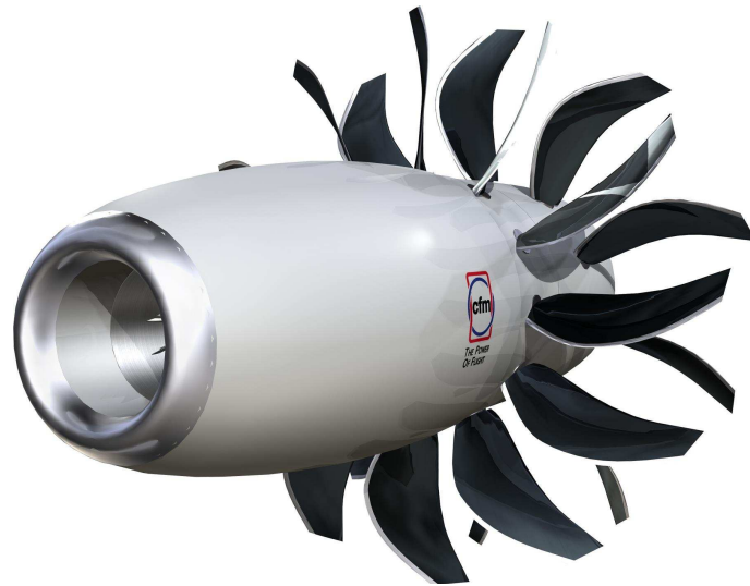
FIGURE 5.1 – Maquette de l'open rotor développé par Snecma [166]
