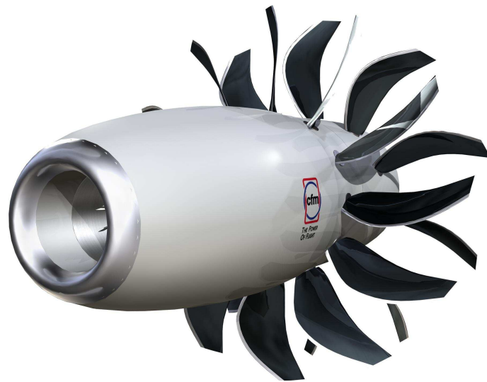
FIGURE 5.1 – Maquette de l'open rotor développé par Snecma [166]
