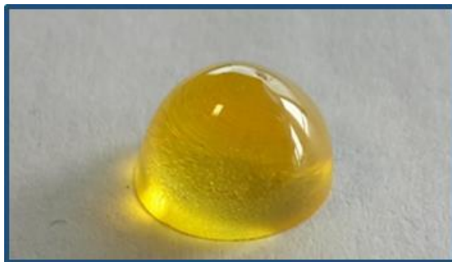
Figure VI.2. La membrane sensible aux ions de sodium à la composition 15NaCl-68GeS 2 -17Ga 2 S 3 .
