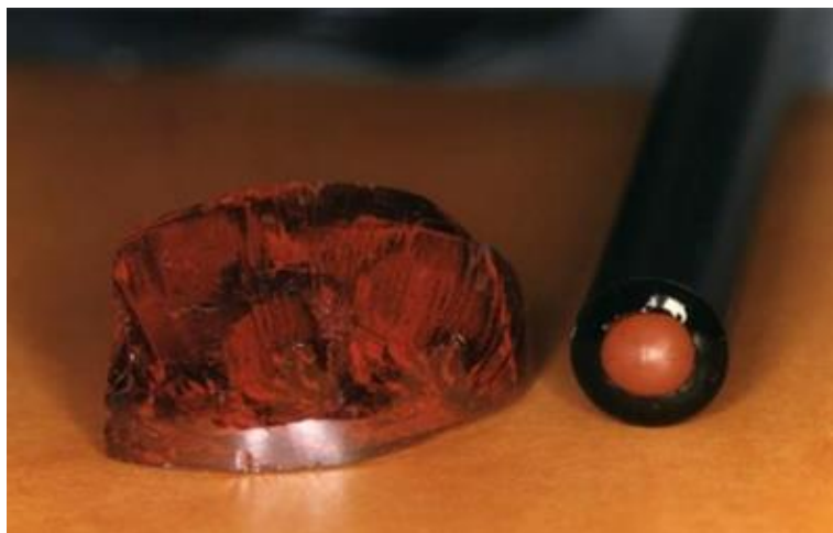
Figure I.10. L'exemple de capteur chimique avec la membrane à la base de verre chalcogénure.
