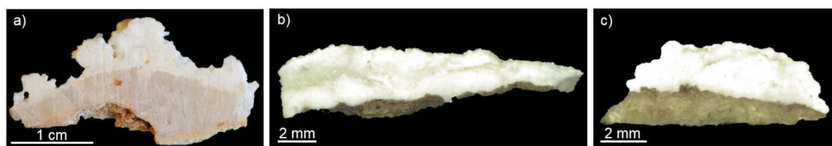
Figure 61. Coralloïdes analysés par LIBS en mode imagerie. a) Coralloïde type « chou-fleur » (BDX 16796) ; b) Coralloïde type « chou-fleur » à surface aciculaire (BDX 17341) ; c) Coralloïde type « bouton » (BDX 17340). Clichés F. Pelascini et L. Bassel.
