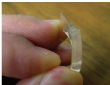
Figure 1.23 : Dispositif de microfluidique obtenu par contact et recuit de deux substrats revêtus de polymères [57]
