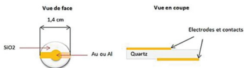
Figure 1.29 : Schéma d'une microbalance à quartz
