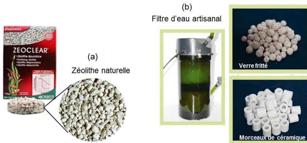
Figure I-29. Exemples de matériaux poreux utilisés dans le traitement de l'eau pour la rétention de bactéries et d'autres macro polluants : (a) zéolithe naturelle commercialisée (Zeoclear® de chez Actizoo); (b) système d'assainissement d'eau d'aquarium fabriqué à partir de verre fritté, de morceaux de céramique et de charbon actif poreux [251].
