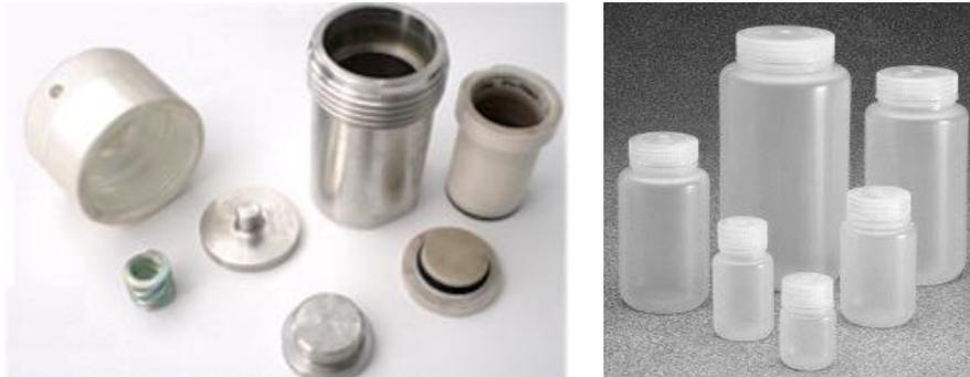
Figure II-2. Exemples de flacons en PP (à droite) et d'autoclave en acier inoxydable avec sa chemise en Téflon® (à gauche) utilisés.
