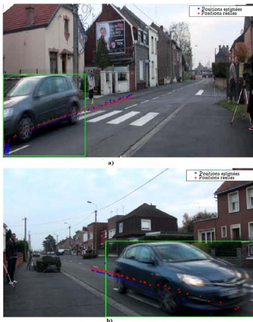
FIGURE 4.16 – Superposition des trajectoires estimées et de celles de réalité du terrain.
