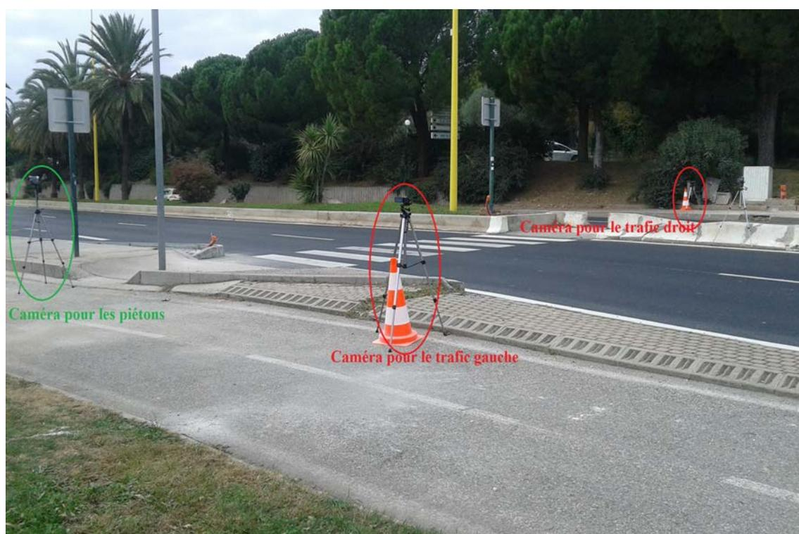
FIGURE 5.18 – Présentation de la zone de tournage, La Garde à Toulon, avec les dispositions des caméras : Les caméras encerclées en rouge sont les caméras pour filmer le trafic gauche et droit et la caméra encerclée en vert est pour filmer les piétons.
