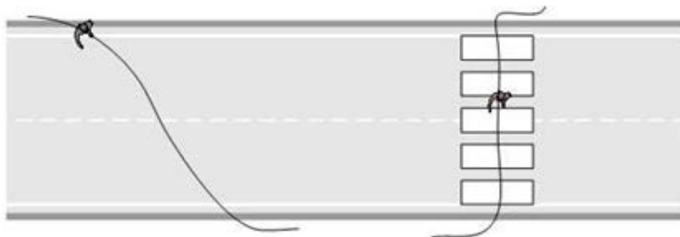
FIGURE 2.13 – Trajectoires d'un piéton traversant une route, hors (à gauche) et sur (à droite) un passage piéton [13].
