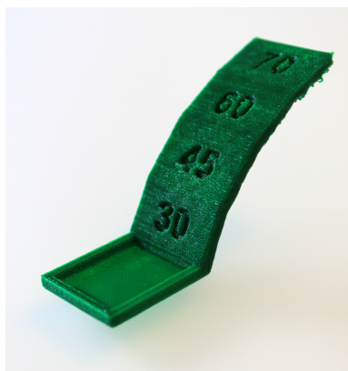
Figure IX.6 – Exemple de pièce test permettant d'évaluer la capacité d'une imprimante à produire des structures en porte-à-faux. source : http://3dprintingforbeginners.com/pirx-3d-printer-review/
