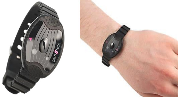
Figure 4. Exemple d'un actimètre de poignet (MotionWatch 8®, Cambridge Neurotechnology, Cambridge, UK, http://www.camntech.com/products/motionwatch/motionwatch-8-overview ).
