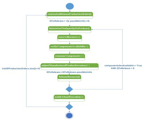
FIGURE 3.16: THE PRODUCE OPERATION STATE MACHINE
