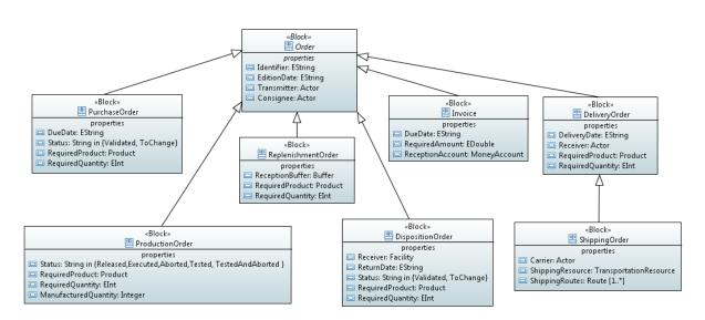
FIGURE 3.10: BLOCK DEFINITION DIAGRAM OF INFORMATION FLOWS OF TYPE "ORDER"
