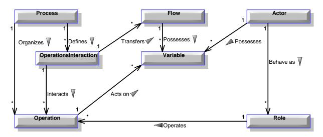
FIGURE 3.8: THE BEHAVIOR META-MODEL BLOCK DEFINITION DIAGRAM
