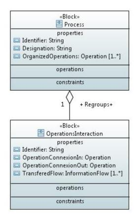
FIGURE 3.18: THE PROCESS BLOCK DEFINITION DIAGRAM
