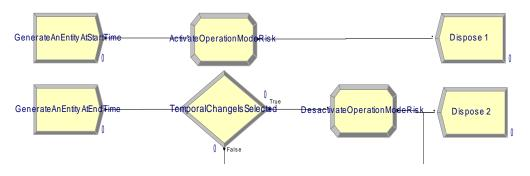
FIGURE 4.12: FLOWCHART OF THE OPERATION MODERISK ARENA MODULE
