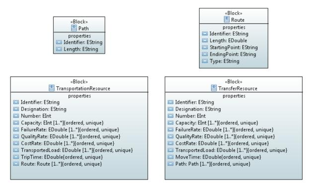
FIGURE 3.7: TRANSPORTATION NETWORK VIEW BLOCKS DEFINITION DIAGRAM
