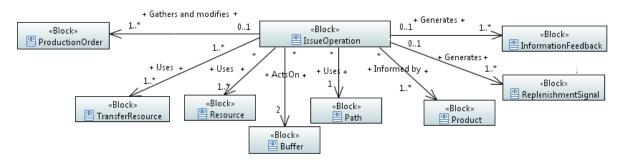
FIGURE A1.1: THE ISSUEMATERIAL OPERATION BLOCK DEFINITION DIAGRAM
