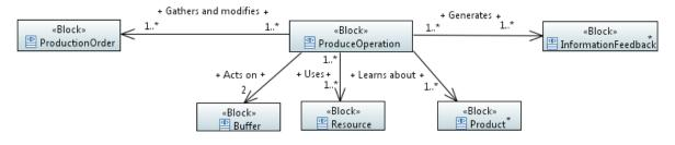
FIGURE 3.14: THE PRODUCE OPERATION BLOCK DIAGRAM
