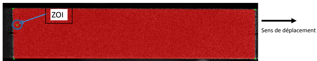
Figure II. 6 : Sélection de la zone d'analyse et de la zone d'intérêt pour la corrélation d'images.
