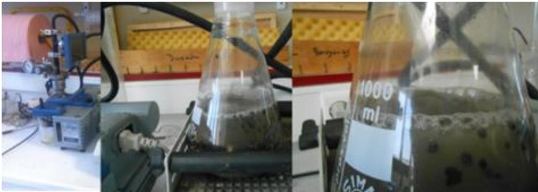
**Figure 43: Pycnomètre à eau pour la mesure de la masse volumique des particules de 2/20 mm**
