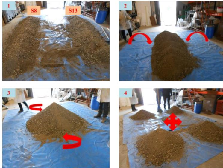
**Figure 35: Les étapes d'homogénéisation des matériaux**
