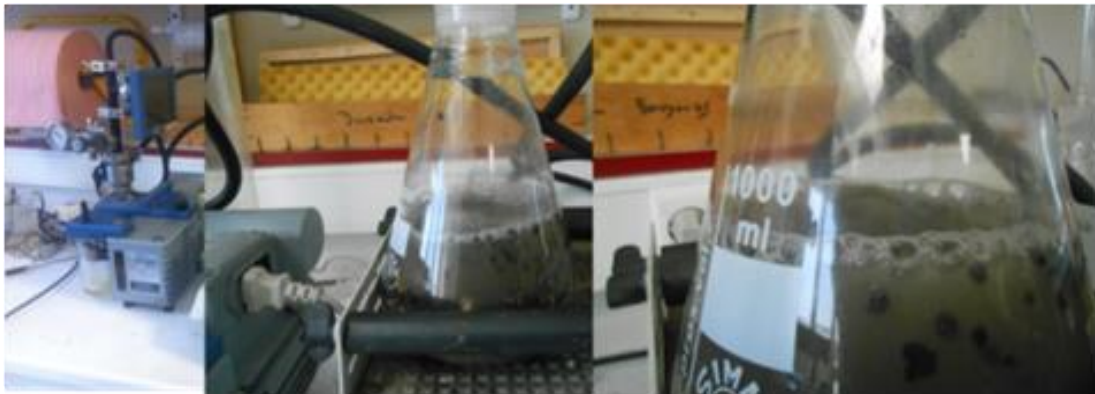
Figure 43: Pycnomètre à eau pour la mesure de la masse volumique des particules de 2/20 mm
