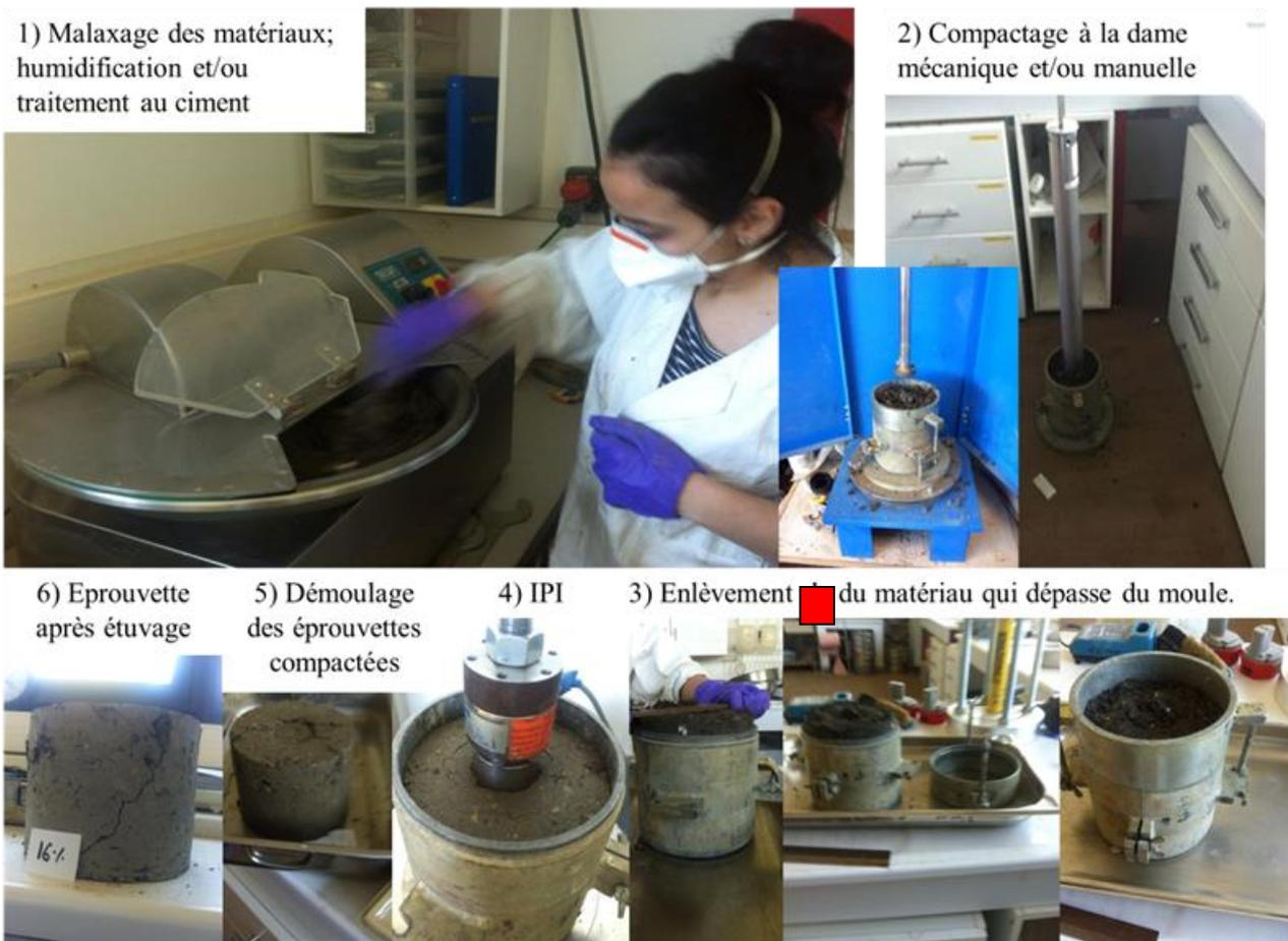
**Figure 57: Les étapes d'un essai de compactage Proctor**
