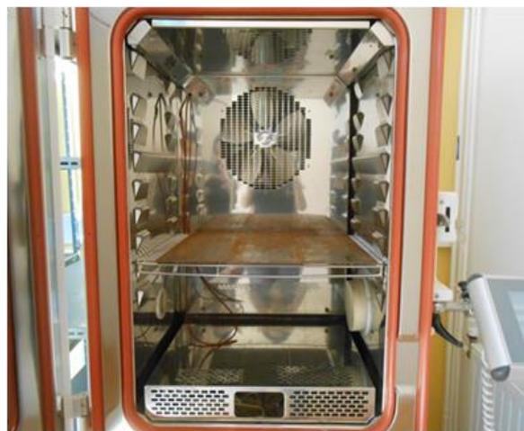
**Figure 61: Photo d'une enceinte climatique**
