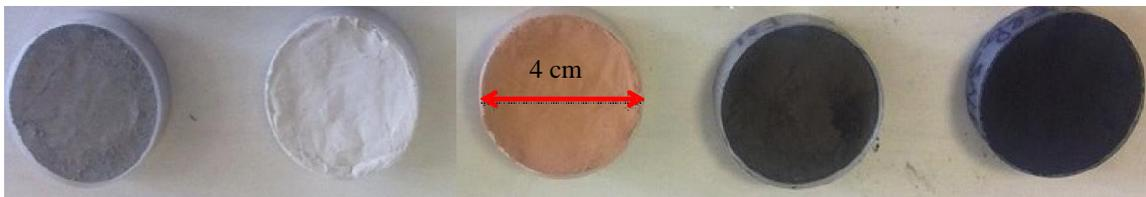
Figure 47: Exemple de poudres analysées par XRF
