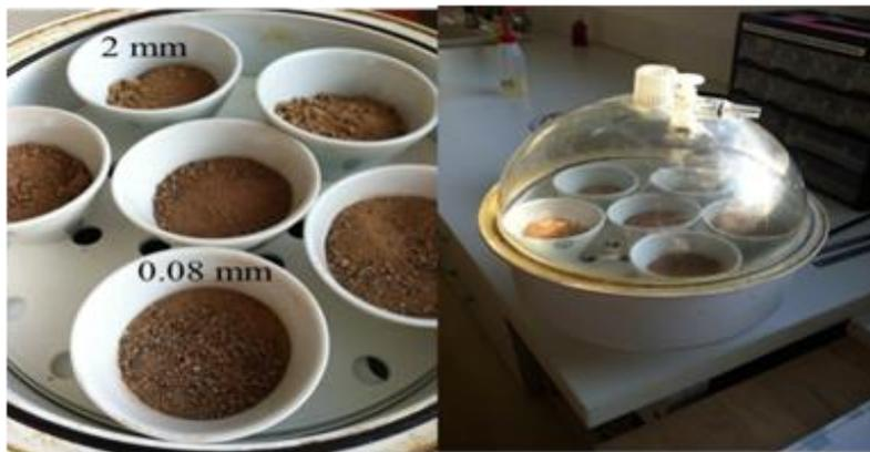
Figure 41: Échantillon de sol après calcination à 550 °C
