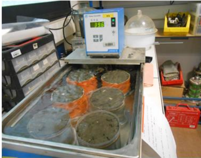
Figure 62: Bain thermostaté à 40°C avec les éprouvettes immergées et destinées à la mesure de gonflement
