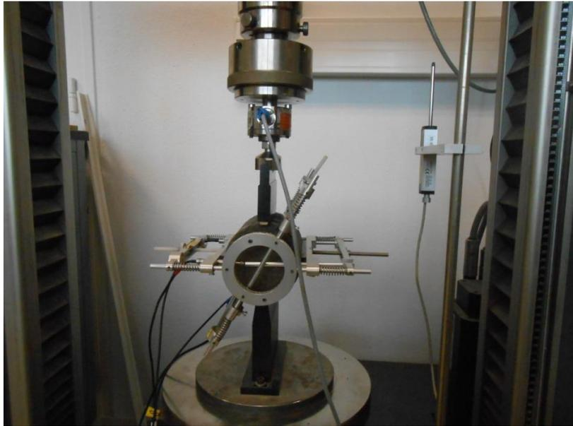
Figure 64: Dispositif expérimental de l'essai de détermination de la résistance à la traction indirecte (éprouvette, capteurs de déplacement et presse de compactage)
