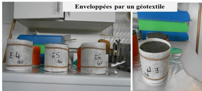
Figure 60: Éprouvettes destinées à la mesure du gonflement volumique (GV)
