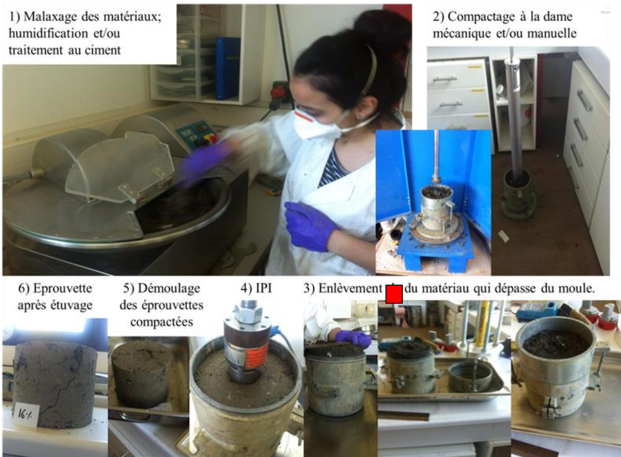
Figure 57: Les étapes d'un essai de compactage Proctor
