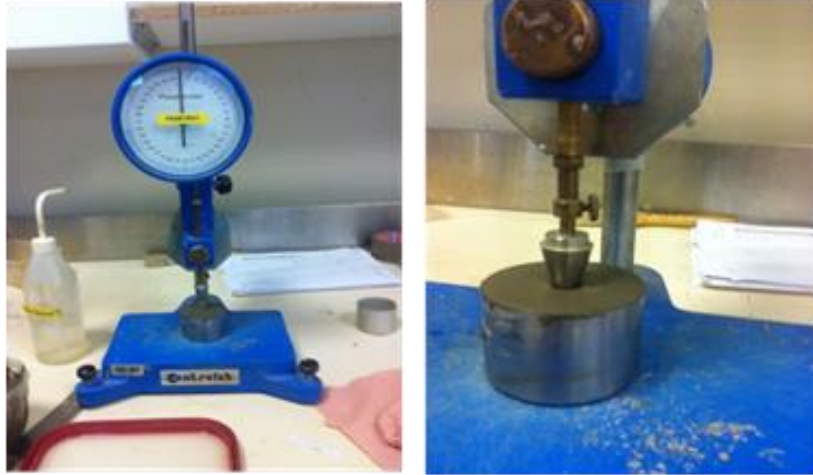
Figure 38: Cône de pénétration pour la mesure de la limite de liquidité ( w_L )
