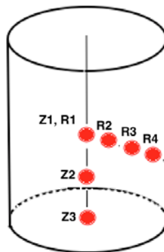
FIGURE IV .7: Schéma représentant les six localisations spatiales de la source de ^{239}\text{Pu} au sein du fût de déchets
