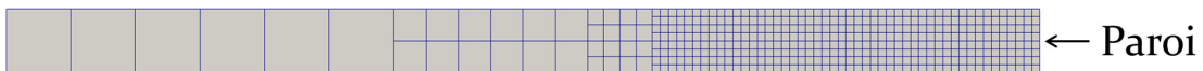
FIGURE 2.17 – Coupe du maillage allant des mailles les plus grossières aux plus fines en paroi (64 mailles en paroi sur le domaine complet sur cette image) .
