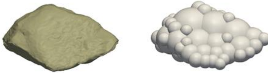
Figure 2.8: une pierre (gauche) et sa représentation multisphérique (droite)
