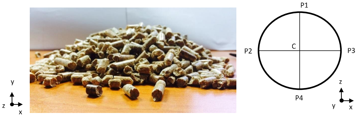
Figure F.1: Angle de repos statique pour les granulés (à gauche) et le schéma des points de mesure P1, P2, P3 et P4 dont le centre est le point C (à droite)
