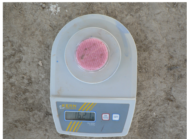
Fig. 85 : un test normalisé (test de l'éponge. Norme UNI 11432 :2011.1) montre l'efficacité du mélange (Gandreau, Razzokov, Sadozai, 2013). L'absorption capillaire diminue lorsque l'on ajoute de la balle de riz. Le temps de cure humide du mélange est également un facteur important pour optimiser les résultats. (©CRAterre, D. Gandreau, 2013)
