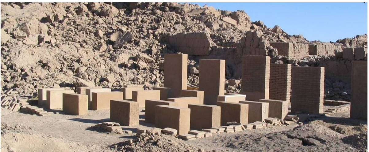
Fig. 125 : murets tests disposés sur une aire d'expérimentation à l'intérieur de la citadelle. (©CRAterre, D. Gandreau, 2005)
