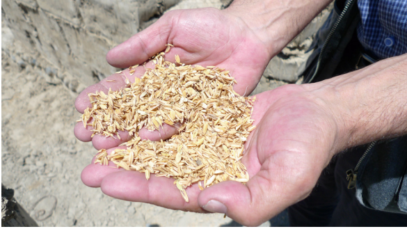
Fig. 83 : la balle de riz, disponible en grande quantité après la saison des récoltes et du décortiquage des plantes de riz pour en extraire les grains, est utilisée dans la construction contemporaine dans les environs de Sarazm. (©CRAterre, D. Gandreau, 2013)
