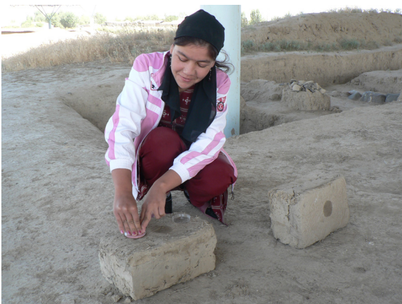
Fig. 85 : un test normalisé (test de l'éponge. Norme UNI 11432 :2011.1) montre l'efficacité du mélange (Gandreau, Razzokov, Sadozai, 2013). L'absorption capillaire diminue lorsque l'on ajoute de la balle de riz. Le temps de cure humide du mélange est également un facteur important pour optimiser les résultats. (©CRAterre, D. Gandreau, 2013)
