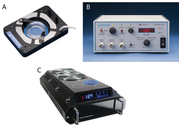
Figure 122 : système de régulation de température par effet Peltier de Warner Instrument. A : Porte échantillon composé d'un système Peltier (Thermal Insert (TB-3 CCD)). B : Système électronique de régulation de la température (Bipolar temperature controller (CL-100)). C : Système hydraulique (Liquid cooling system (LCS-1)).
