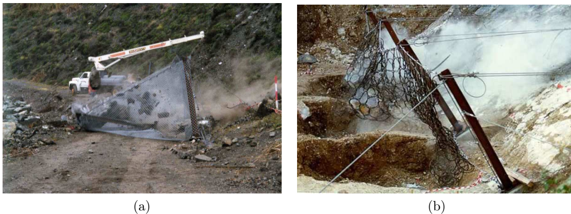
FIGURE 1.6 – Essais d’impacts sur écrans par un bloc se propageant dans un talus : (a) impact sur un poteau (source [Duffy and Hoon, 1996b]); (b) impact simultané de deux blocs (source [Duffy and Haller, 1993])
