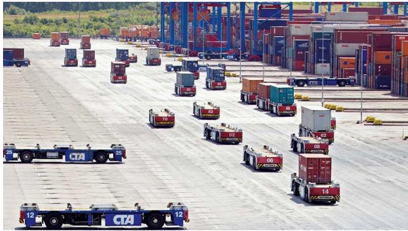
Figure I.15 Le sous-système de transport (une flotte d'AGV)
