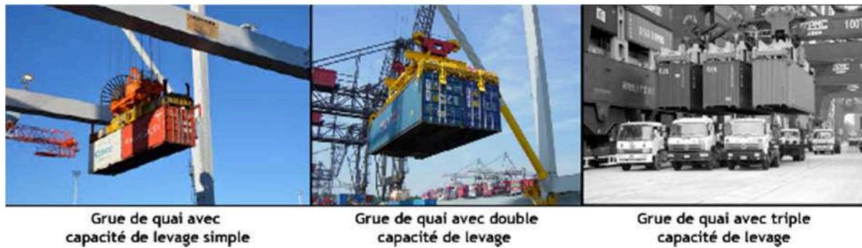
Figure I.9 Capacité de levage des grues de quai
