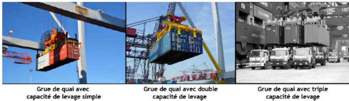
Figure I.9 Capacité de levage des grues de quai
