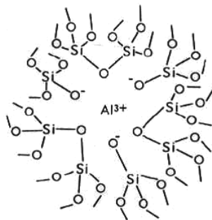
Figure 18 : Structure de l'aluminium en coordinence 6 entouré de trois atomes d'oxygènes pontants et de trois atomes d'oxygènes non-pontants selon le modèle de Day et Rindone [18].
