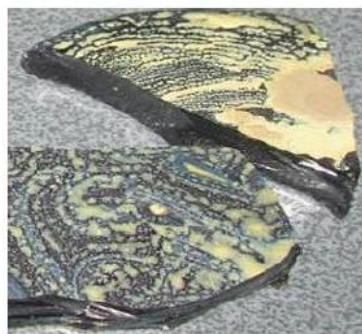
Figure 10 : Photographie d'un verre de type R7T7 à taux de charge élevé en MoO_3 (3 % massiques) élaboré en laboratoire et refroidi par coulée sur plaque. La « yellow phase » est observée à la surface du verre [50].
