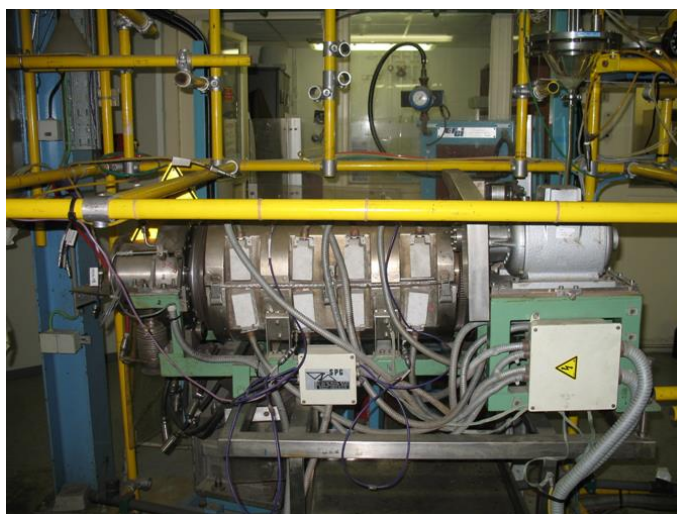
Figure 43 : Prototype de calcination industrielle petite échelle ELVIS.
