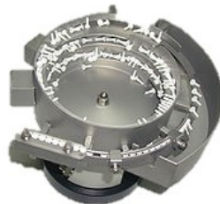
FIGURE 2.1 – Le bol vibrant véhicule les objets dans une goulotte par vibrations
