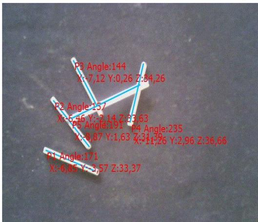
(b) ThOR : Recherche d'objets positionnés avec un enchevêtrement.
